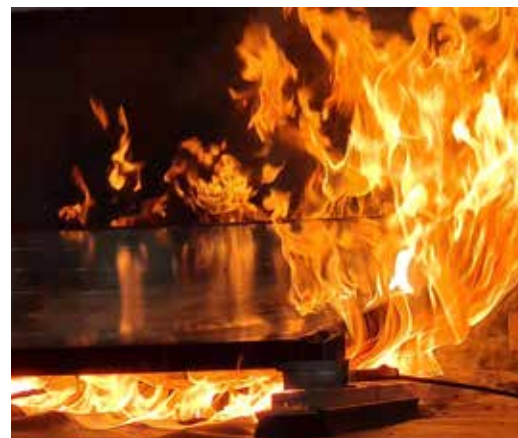
Incendie induit par l'arc électrique sous une toiture solaire plate au laboratoire d'essai au feu ZAG
