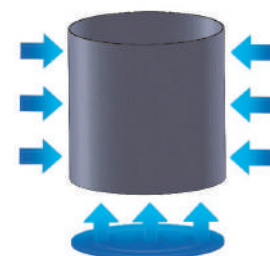
Refroidissement par le fond et les cotés
