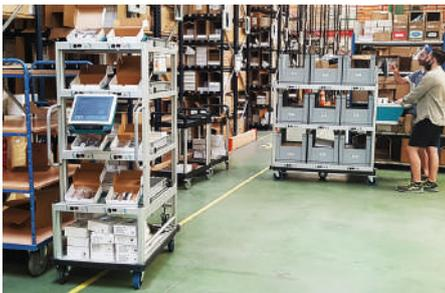
Chariots de picking put to light avec pilotage IT (ONE CS+)
