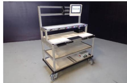
Chariot de kitting put to light à contrôle pondéral et pilotage IT
