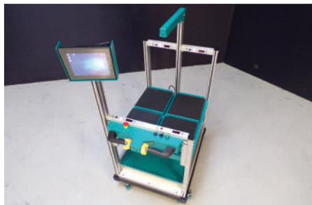
Chariot de kitting motorisé put to light, contrôle pondéral, caméras & pilotage IT
