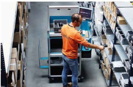
Chariot de kitting put to light, contrôle pondéral, caméras & pilotage IT
