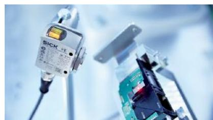
Les deux LED de couleur indiquent l'état de détection en temps réel.
