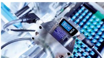
Grâce aux réglages par défaut, le W10 est opérationnel dans une multitude d'applications.
