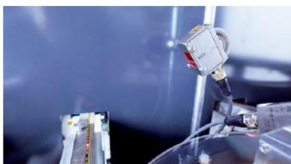
Du mode « Speed » pour les applications rapides en passant par le mode « Precision » pour des applications de positionnement précises jusqu'au mode « Standard » pour l'utilisation dans des conditions difficiles, le W10 offre la bonne solution pour des applications différentes.
