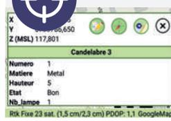
Contrôlez la précision obtenue grâce au récepteur GPS/GNSS du smartphone ou avec un récepteur GNSS externe de précision métrique à centimétrique.
