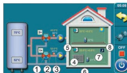
Il est possible de contrôler graphiquement le fonctionnement des deux circuits de chauffage pilotés par l'unité CM2K à l'aide de l'écran ci-dessus sur la chaudière GMX EASY.
