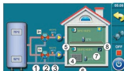
Il est possible de contrôler graphiquement le fonctionnement des deux circuits de chauffage pilotés par l'unité CM2K à l'aide de l'écran ci-dessus sur la chaudière SX EASY.
