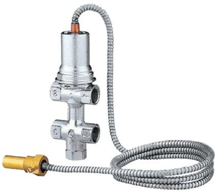
Appareil combinant en un corps unique la soupape de décharge thermique et un dispositif d'alimentation d'eau qui fonctionne simultanément, commandés par une sonde à distance (1,30 m maxi).
