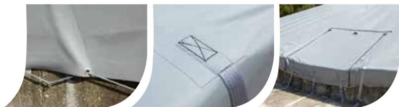
Des œillets inox tous les 25 cm fixés par un sandow de diamètre 10 mm sur crochets inox.
