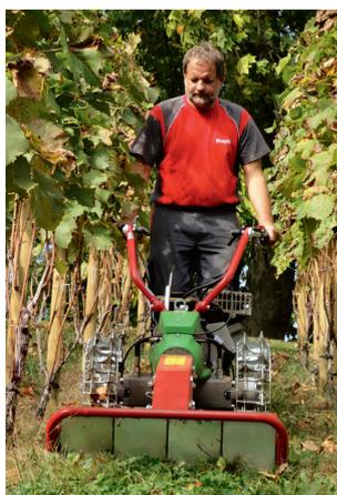
Les débroussailleuses écologiques Rapid conviennent parfaitement pour le mulching des broussailles et des espaces verts. Les lames en acier massif tournant horizontalement ont une performance de coupe élevée. Le produit de coupe finement haché est généralement laissé au sol. Cette manière de travailler permet un entretien rapide et propre des différents types d'espaces verts.
