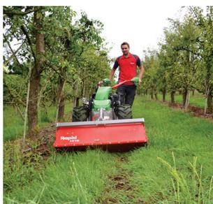
Les débroussailleuses à fléaux de Rapid coupent et hachent finement l'herbe comme les broussailles, et répartissent les produits coupés uniformément sur le sol. Les couteaux en Y extrêmement résistants et montés de manière mobile sur l'arbre équilibré permettent un travail sans vibration avec une grande efficacité. Le résultat est une coupe propre sur des espaces verts parfaitement bien entretenus.
