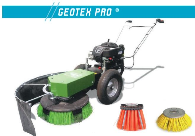
Fournie avec une brosse GEO TECH Ø 52 cm pour le nettoyage des géotextiles + une brosse WEEDY Ø 45 cm pour le désherbage en surface et dans les joints + un balai SWEEPER Ø 70 cm pour le nettoyage
