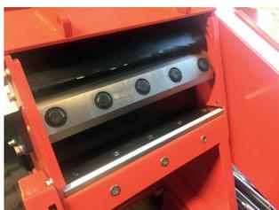
Détail du rotor avec couteaux et contre couteaux
