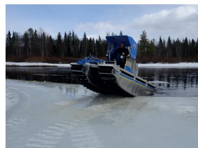
Ses propriétés amphibies permettent d'accéder au chantier sans grutage ni terrassement d'une mise à l'eau.
