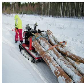
Puissance et motricité incroyables, permettant de porter ou tracter de très gros chargements : jusqu'à 700 kg sur la plateforme et 2 000 kg en remorque. Chenilles à crampons acier en option.
