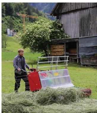
La Rapid Multi-Twister dispose d'un convoyeur à bande avec lequel le produit de fauche récolté à l'aide du pick-up à doigts est évacué activement sur le côté. Une utilisation sur terrain plat ou en pente est donc envisageable. L'évacuation active accroît en outre le spectre d'utilisation quant au fourrage vert et à l'ensilage. De plus, le convoyeur à bande permet l'utilisation du Multi-Twister pour l'andainage.
