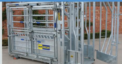
Le Crusader Plus est notre entrée de gamme de la cage d'immobilisation de bovins, qui est adapté à la fois aux bovins laitiers et aux bœufs et est doté à l'avant d'un levier à commande manuelle qui actionne le joug situé de chaque côté de la cage d'immobilisation. Pour une polyvalence maximale, un réglage rapide à ressort permet d'obtenir 4 largeurs de joug prédéfinies, de 100mm à 260mm.
