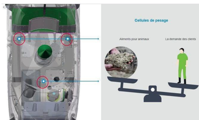
Le DairyFeed F4500 est équipé de 3 pesons. Les rouleaux démêleurs des stockeurs ralentissent leur vitesse lorsque 75% de la ration programmée est chargée, ce qui permet d'être très précis dans la pesée des aliments.
