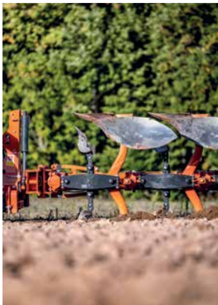
Les ailes profilées suppriment les risques de bourrage en présence de résidus
