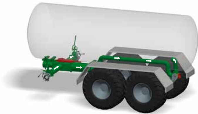
Principe de fonctionnement « remplissage » d'une tonne à lisier avec pompe à colimaçon
