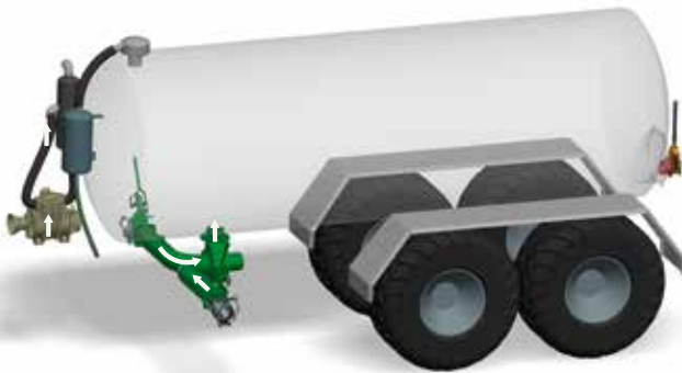
Principe de fonctionnement « remplissage » de la tonne à lisier avec dépression
