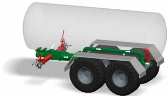
Principe de fonctionnement « épandage » d'une tonne à lisier avec pompe à colimaçon
