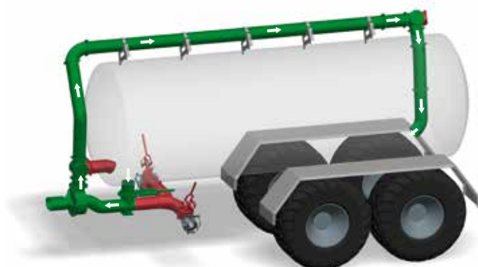
Principe de fonctionnement « agitation » de la technologie Power-Boost
