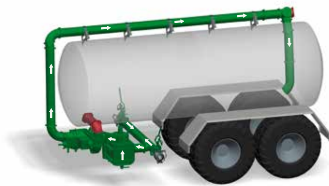
Principe de fonctionnement « remplissage » d'une tonne à lisier avec pompe à lobes
