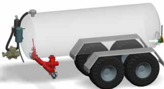
Principe de fonctionnement « vidange » de la tonne à lisier avec surpression
