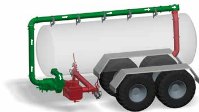
Principe de fonctionnement « épandage » d'une tonne à lisier avec pompe à lobes
