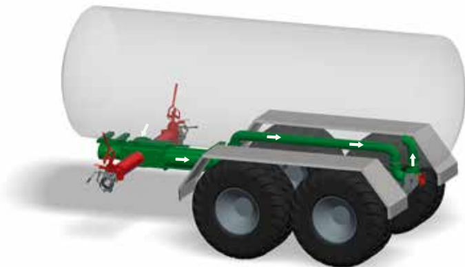
Principe de fonctionnement « agitation » d'une tonne à lisier avec pompe à colimaçon
