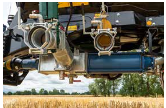
Pompe à colimaçon Wangen GL 65 F 140.0
