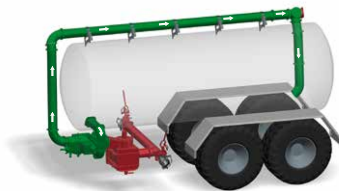
Principe de fonctionnement « agitation » d'une tonne à lisier avec pompe à lobes
