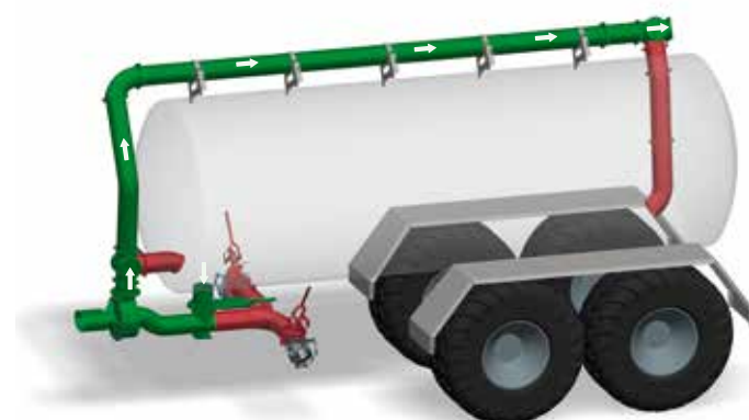
Principe de fonctionnement « vidange » de la technologie Power-Boost
