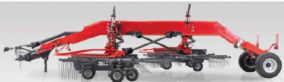
Le levage séquentiel des rotors (SRL) équipé en série offre un délai supplémentaire du levage partiel des rotors, que l'utilisateur peut ajuster en fonction de la quantité de fourrage et des spécificités du champs.
