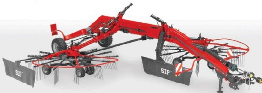
La combinaison de rotors à réglage télescopique et de rideaux d'andainage avant et arrière à réglage hydraulique, permet le dépôt de deux andains simples ou d'un andain double. Les deux rideaux d'andainage sont fournis en standard sur la machine, le rideau arrière étant réglable de manière télescopique.
