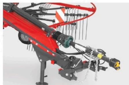
L'attelage pivotant relié au mécanisme de direction robuste offre un angle de braquage de 75,5°.
