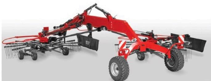
La nouvelle conception du châssis en forme d'arc offre plus d'espace de manœuvre lors du passage sur les andains, car l'ensemble du châssis de l'andaineur est positionné plus haut. L'essieu arrière élevé du châssis de transport assure également un passage rapide et facile sur les andains.
