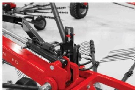
Avec un réglage hydraulique standard de la hauteur des rotors et une graduation sur les bras, la hauteur de travail peut être facilement ajustée depuis la cabine du tracteur.
