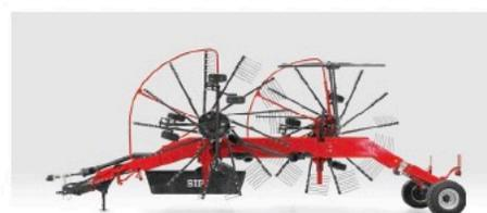
Le système de verrouillage par clic des rails de sécurité et le verrouillage automatique des rotors en position de transport assurent la sécurité et la stabilité pendant le transport. La largeur de transport est inférieure à 3 m et la hauteur de transport avec les bras montés est inférieure à 4 m.
