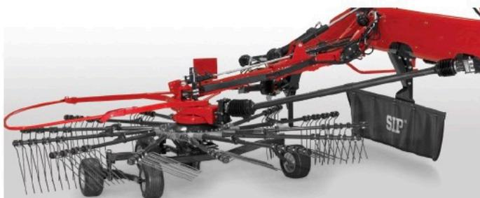
La suspension hydropneumatique et le support 3D+ des rotors, en combinaison avec un essieu tandem mobile, permettent une adaptation parfaite au terrain sans dommage pour la pelouse ni contamination du fourrage.
