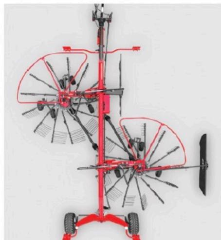
Les rotors sont entraînés par un nouvel entraînement Z-drive breveté. Grâce à la disposition innovante de l'entraînement de la prise de force, le Z-drive permet d'obtenir des angles d'arbre de prise de force plus petits, des angles de réglage plus grands et des levées partielles plus élevées. Ainsi, vous bénéficiez d'une plus longue durée de vie et d'une réduction des dommages sur les arbres de prise de force, ainsi que d'une excellente maniabilité de la machine.
