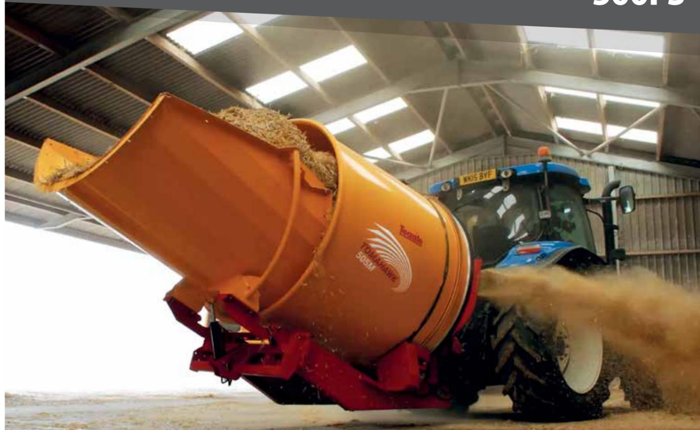
Broyage et calibrage des fourrages secs pour rations mélangées, paillage des logettes et litière des volailles
