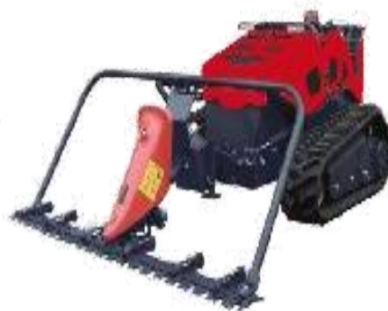
Barre de coupe Largeur:150 cm Poids : 100 kg
