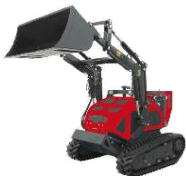
Chargeur frontal Largeur : 130 cm Hauteur de levée : 1 m Poids : 300 kg
