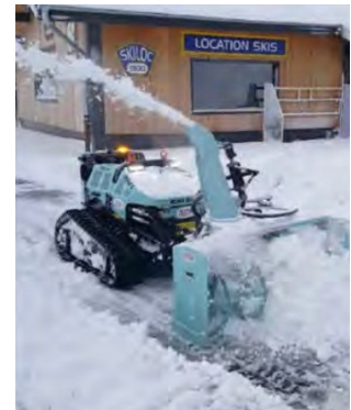
Fraise à neige PRONOVOST Largeur : 140 cm Poids : 170 kg
