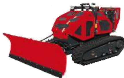
Lame à neige Largeur : 150 cm Poids : 110 kg
