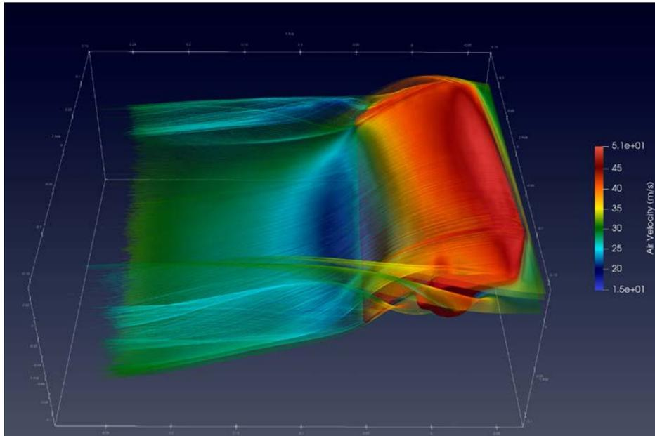
Cette nouvelle forme réduit la formation de tourbillons et permet ainsi un fonctionnement plus efficace du ventilateur.
