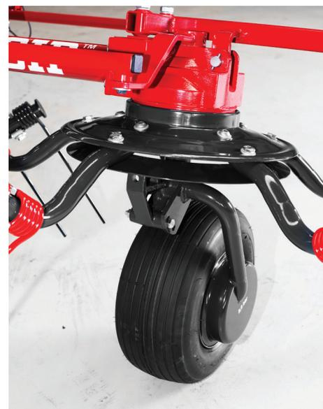
Roues avec réglage rapide de la hauteur et de l'angle d'épandage.
