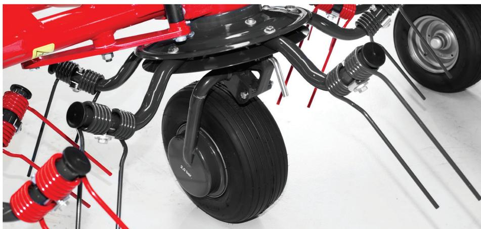
Roues avec réglage de la hauteur et de l'angle d'épandage selon la quantité et l'humidité du fourrage.
