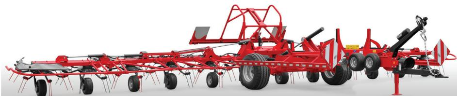
La géométrie innovante des rotors de petit diamètre avec des dents à ressort de différentes longueurs garantit un flux de fourrage optimal et un épandage uniforme. Le SPIDER 1300 | 12 T avec douze rotors couvre idéalement 5 rangées de faucheuse avec 7 disques et 3 m de largeur de travail.
