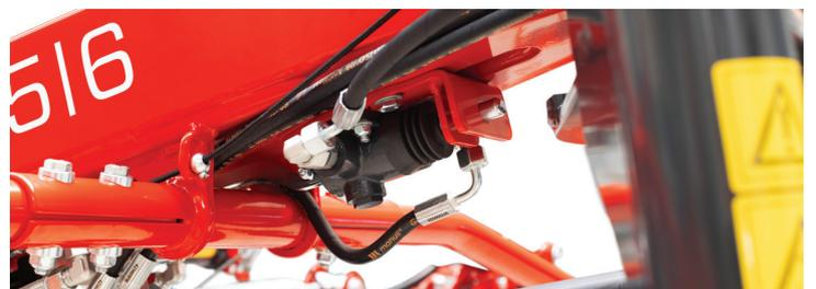
Le système SMART LIFT verrouille automatiquement et soulève en plus les rotors externes pendant le levage partiel, permettant une garde au sol plus généreuse.
