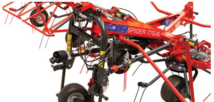
L'attelage flexible avec stabilisation à trois points offre un suivi flexible du tracteur et un équilibrage lors du levage de la machine.
