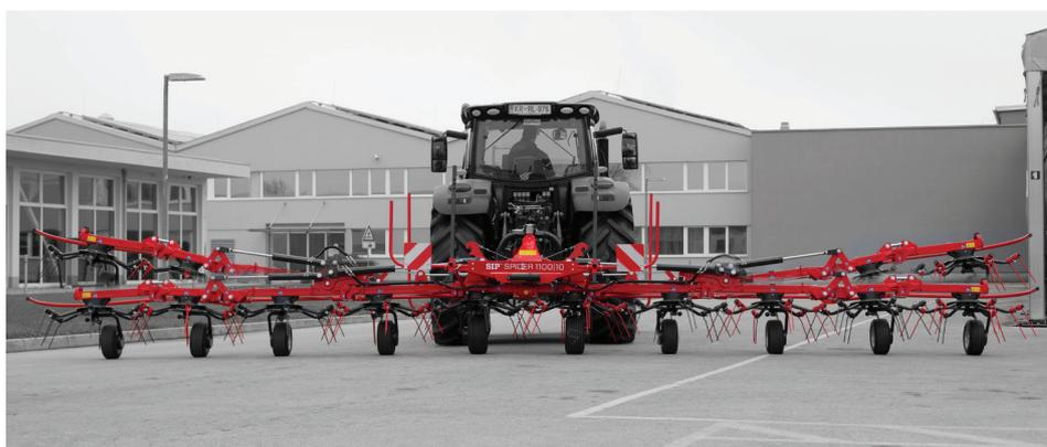
Les rotors segmentés permettent une parfaite adaptation au sol même sur des terrains difficiles.
