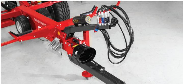
Attelage de timon réglable avec châssis de transport pour des vitesses allant jusqu'à 40 km/h.
