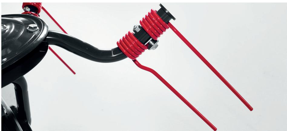
Les dents à ressort de différentes longueurs empêchent les rayures du sol et la contamination du fourrage par la terre ou le sable. La protection à l'extrémité du support empêche la perte des dents à ressort en cas de dommage et la présence de pièces métalliques dans le fourrage, protégeant ainsi les autres machines de récolte des dommages.
