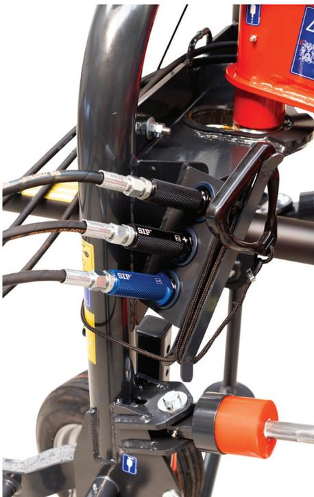
Rangement pratique des connexions hydrauliques et du cordon de déclenchement sur le côté gauche de la connexion.
