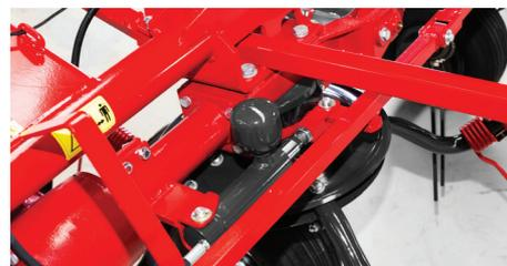
Tous les modèles de la ligne ROBUST sont équipés en standard d'un changement de roue hydraulique central HS pour l'épandage en bordure.
