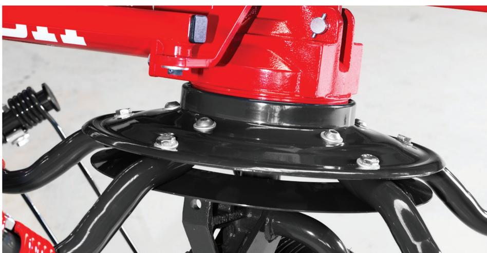
Roues avec réglage de la hauteur et de l'angle d'épandage selon la quantité et l'humidité du fourrage.
