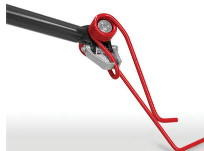
Les dents à ressort à crochet (en option) permettent le levage du fourrage en deux couches, ce qui augmente l'efficacité d'épandage sur les modèles de faneuse avec un plus grand diamètre de rotor.
