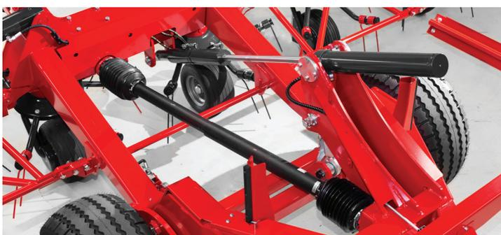
Le système innovant de pliage hydraulique permet une préparation facile au travail et une stabilité lors des passages.
