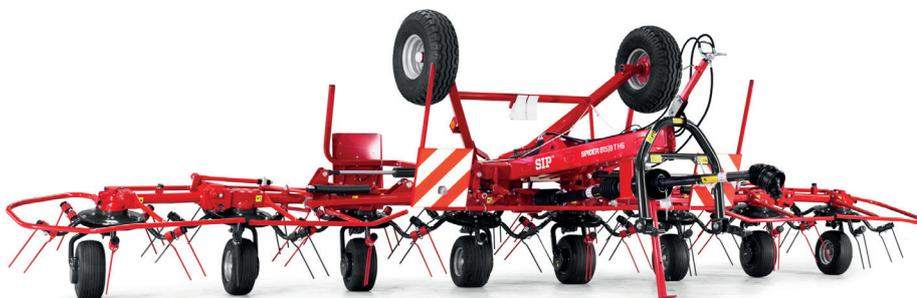
La version traînée de la faneuse avec une prise de force grand angle permet un excellent suivi du tracteur et un rayon de braquage plus petit.
