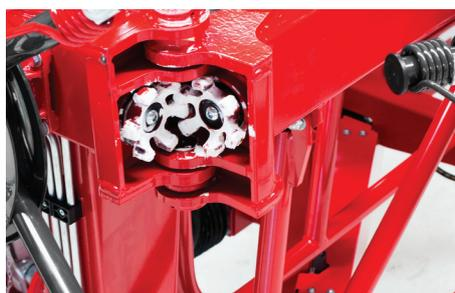
L'entraînement à doigt sur chaque charnière pour un fonctionnement doux et silencieux et une réduction de la charge.
