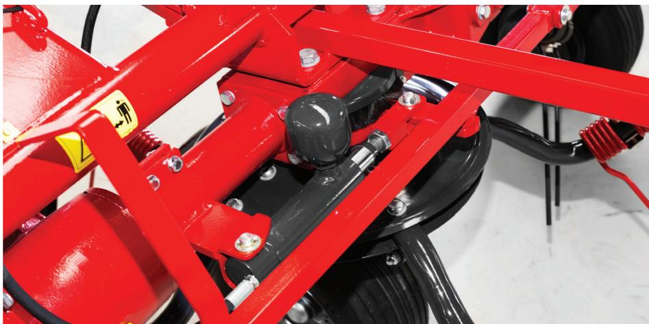
Tous les modèles de la ligne ROBUST sont équipés en standard d'un changement de roue hydraulique central HS pour l'épandage en bordure.
