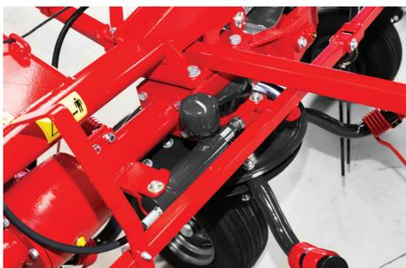
Le système de direction hydraulique (HS) permet de faire tourner les rotors à gauche ou à droite, évitant ainsi la perte de fourrage lors du retournement ou de l'épandage sur les bords.
