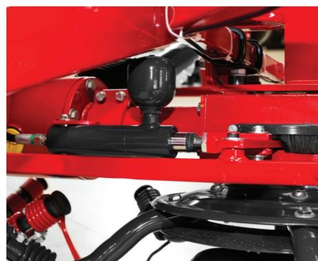
Le vérin hydraulique permet de braquer les roues vers la gauche ou la droite via une connexion hydraulique unidirectionnelle. La contre-pression est dans l'accumulateur hydraulique sur le cylindre.
