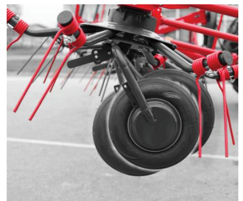
Roues avec réglage en hauteur et en angle d'épandage entre 12° et 18°.
