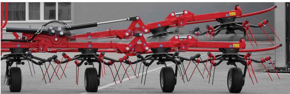
La construction modulaire des rotors individuels connectés permet une large gamme d'adaptation verticale au terrain.
