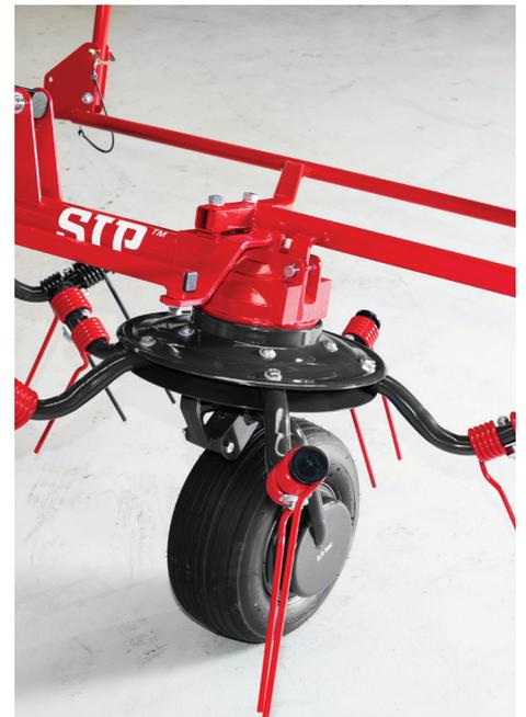
Les porte-dents à ressort sont constitués de tubes ronds très résistants et robustes. La bague inférieure sur le rotor offre un renforcement supplémentaire.
