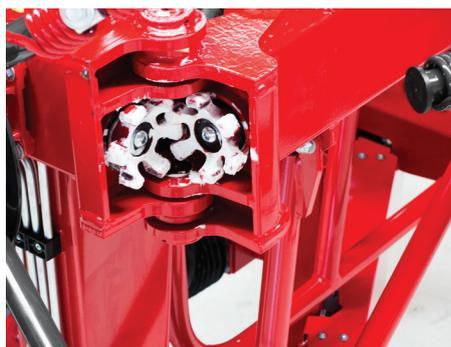
Un entraînement à doigt sur chaque charnière pour un fonctionnement doux et silencieux et une longue durée de fonctionnement.
