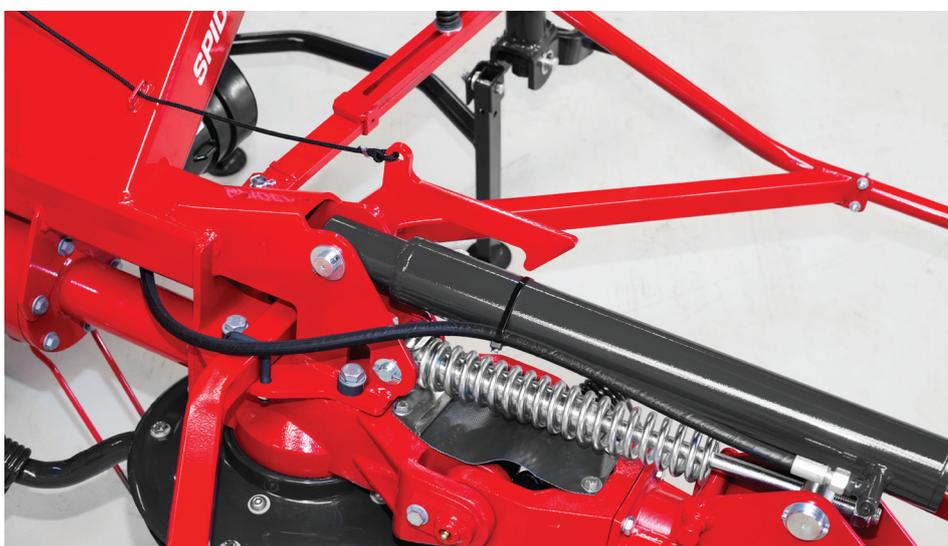
Relevage hydraulique des rotors pour un pliage fluide et rapide.
