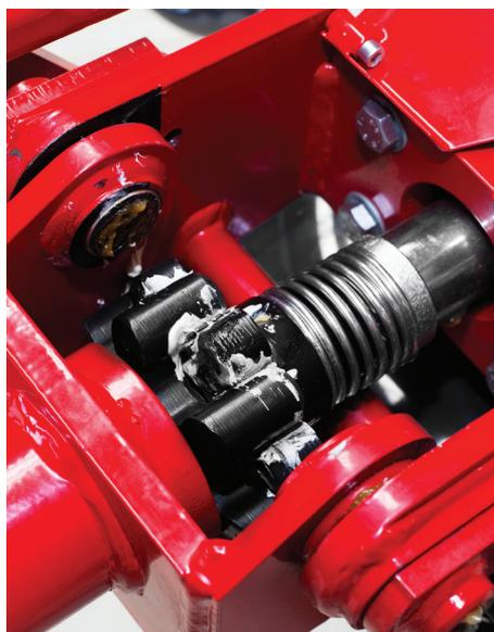
Le mécanisme de pliage des rotors externes en combinaison avec l'entraînement à doigts permet un angle de 180 ° en position de transport compacte.
