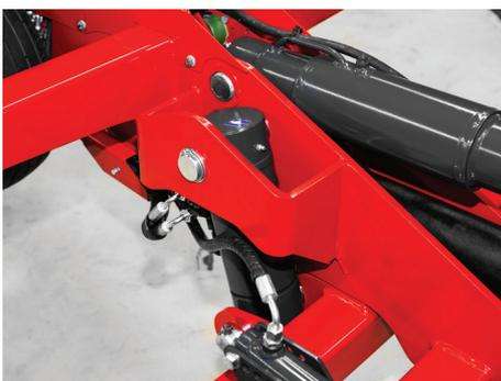
Un système hydraulique breveté pour le réglage de la hauteur du rotor.
