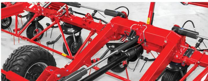
Le système de pliage hydraulique permet une préparation facile pour le travail et le transport et la marche arrière pendant l'épandage.
