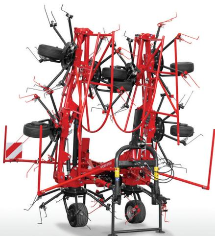
Les rotors avec une plus grande taille de roue assurent une répartition uniforme du poids et réduisent la pression au sol. La dimension de la paire de roues centrale est adaptée à la charge plus élevée de la machine au milieu et pour un repos stable de la machine en position de transport.
