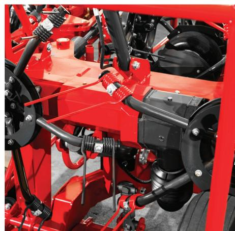
Un embrayage de sécurité en plus de l'entraînement du rotor principal assure une sécurité à 100% du système de rotation.
