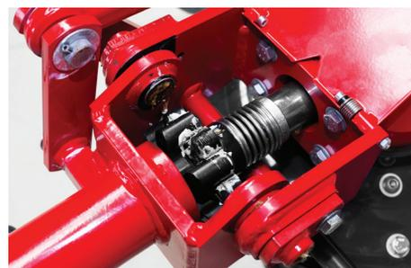
Un double joint universel et un entraînement à doigts dans un boîtier solide assurent un fonctionnement fiable et silencieux ainsi qu'un excellent pliage.
