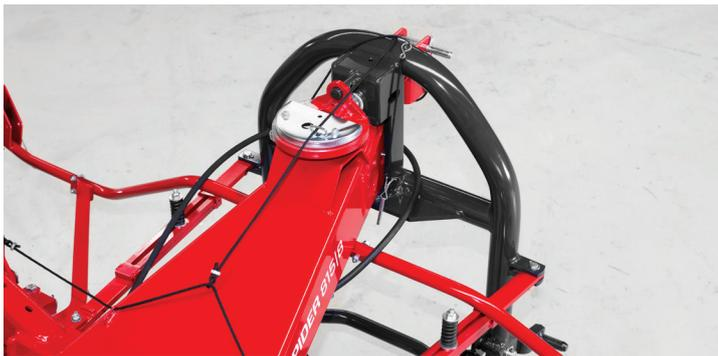
L'attelage pivotant avec stabilisateurs permet à la faneuse de suivre facilement le tracteur.
