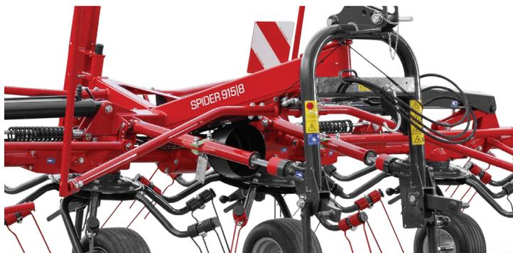
L'attelage flexible avec stabilisation à trois points offre un suivi flexible du tracteur et un équilibrage lors du levage de la machine.
