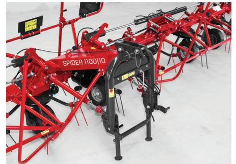
L'attelage pivotant avec hydropneumatique les stabilisateurs assurent un suivi régulier du tracteur.
