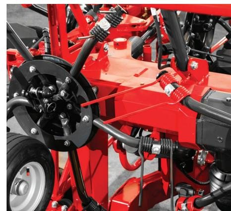
Le double embrayage innovant sur l'entraînement protège la machine des surcharges et évite ainsi d'endommager l'entraînement de la machine.
