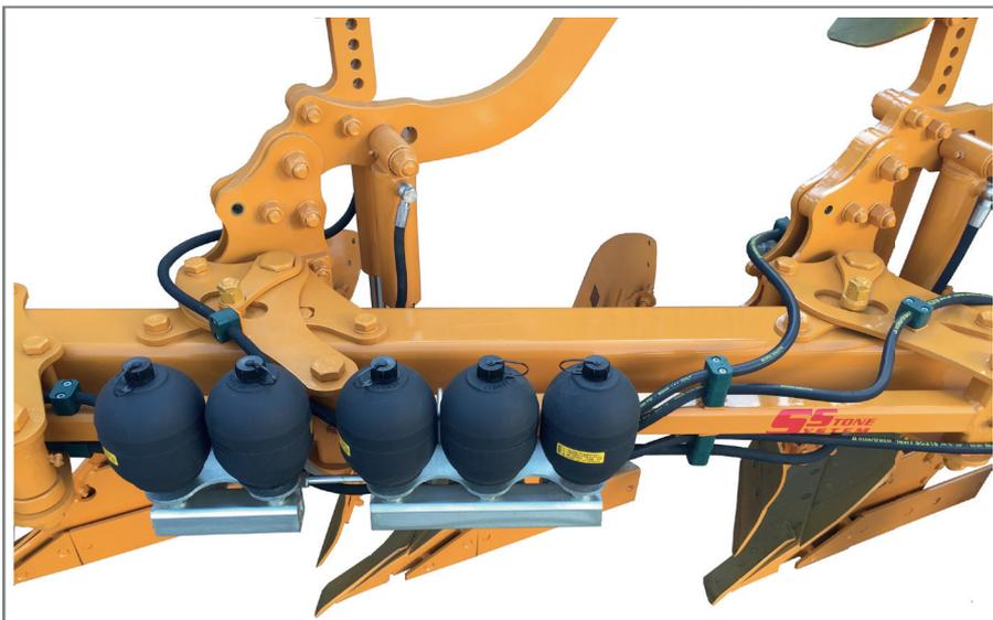
La solution de fabrication consistant à confier la tâche délicate de la protection de la structure à une batterie d'accumulateurs de compensation, et non plus à un simple accumulateur, se traduit par un avantage important en termes de fiabilité.
