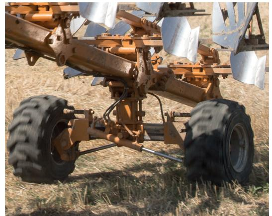
Le passage de la position de travail au système de transport, et vice-versa, est effectué par un entraînement hydraulique. Grâce à la tête d'attelage articulée particulière, la charrue se comporte comme une remorque pendant la phase de transport.
