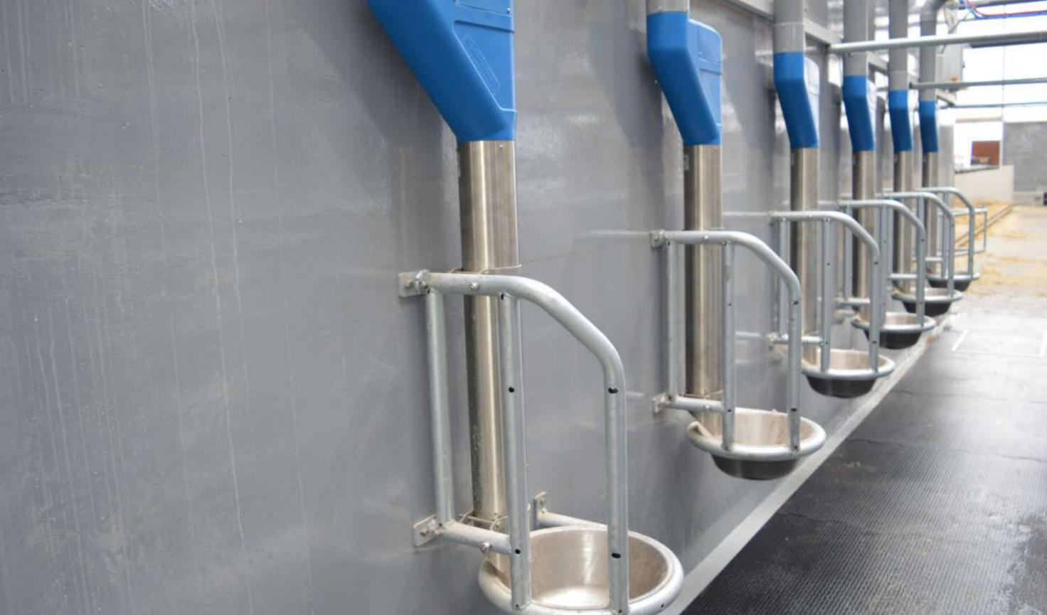
**Le doseur PipeFeeder, précis et anti-gaspillage est idéal en salle de traite, robot, roto ou stations de DAC.**
