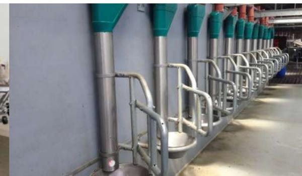
**Le doseur Pipefeeder Hanskamp s'adapte à toutes vos installations : salles de traite, robots, rotos ou stations de DAC. Universel, anti-gaspillage, avec réserve incorporée et de différentes tailles, le PipeFeeder distribue précisément la ration de vos animaux.**
