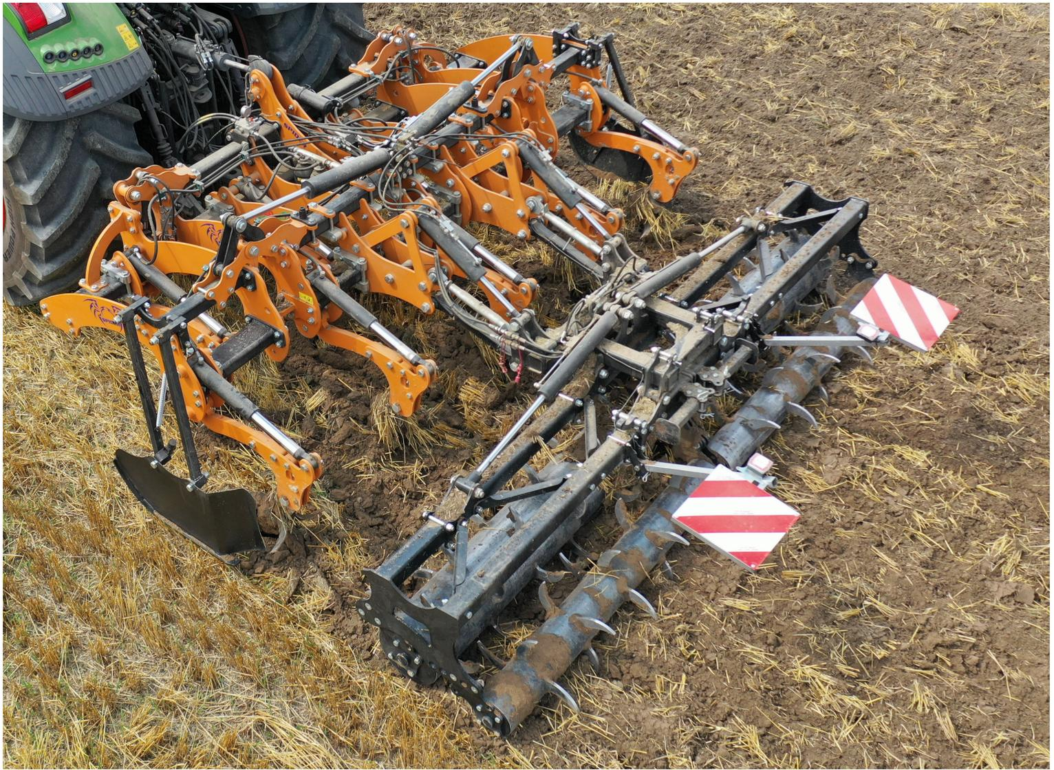
La solution de fabrication consistant à confier la tâche délicate de sauvegarder la structure à une batterie d'accumulateurs de compensation, et non plus à un simple accumulateur, se traduit par un avantage important en termes de fiabilité. Le SPIDER STONE SYSTEM est ainsi en mesure de poursuivre son travail y compris dans l'éventualité d'une panne d'un ou plusieurs accumulateurs.
