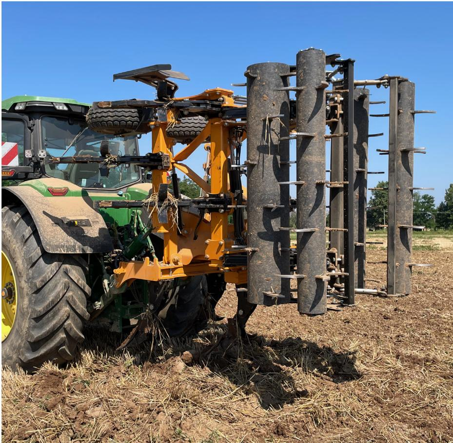
Le décompacteur SPIDER X peut être utilisée seule ou avec le double rouleau spécial RCX dont le réglage hydraulique permet d'ajuster la profondeur de labour. L'association du rouleau avant, d'un diamètre de 360 mm, avec le rouleau arrière de 220mm permet de briser parfaitement les mottes de terre et d'améliorer le nivellement du sol en évitant les bourrages que l'on rencontre avec des rouleaux d'un diamètre inférieur.
