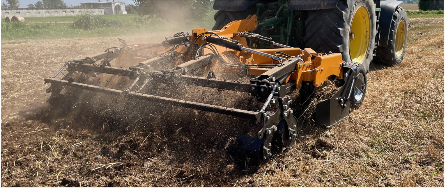
Le décompacteur SPIDER X est disponible dans les versions à 7, 9 et 11 dents. Le double système de repli à 180° permet de réduire la largeur d'encombrement à 2,5 mètres, ce qui facilite son transport.
