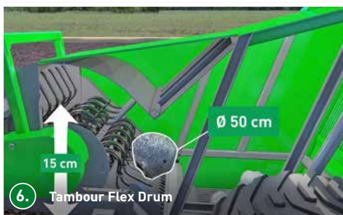
La transmission du tambour de levage est montée sur son châssis, ce qui permet le levage de tout le tambour et du châssis et ainsi de soulever des pierres de 50 cm de diamètre.
