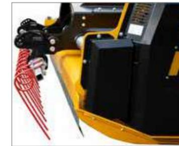
La herse étrille intégrée pourvue de 16 dents non-stop sert à relever les chaumes pressées avant le passage du mulcheur et à produire de la terre fine.
