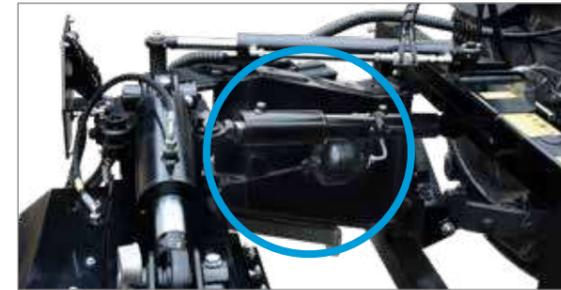
Sécurité anti-collision hydraulique innovante en marche avant et arrière.
