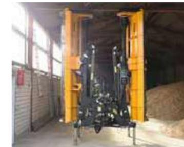
Grâce à sa conception étudiée, le broyeur MU-PRO/F Vario peut être replié pour un faible encombrement d'entreposage.
