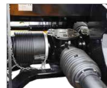
La conception élaborée permet la mise en œuvre d'une double transmission pour une puissance accrue et une meilleure répartition de forces par côté.
