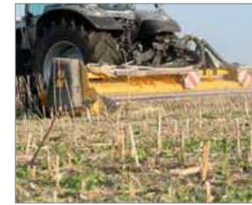
Possibilité d'utiliser le broyeur-mulcheur seul grâce à la facilité de démontage du semoir.
