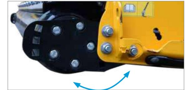
Rouleau d'appui pivotant.
