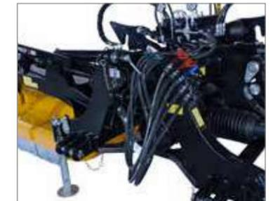
Idéal pour le rangement : système hydraulique de bord avec délestage de pression d'appui hydropneumatique MU-SOFA®.
