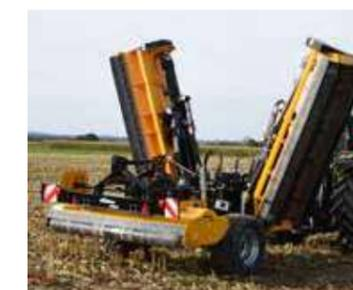
Repliage et déploiement rapides pour une largeur de transport inférieure à 3 m.
