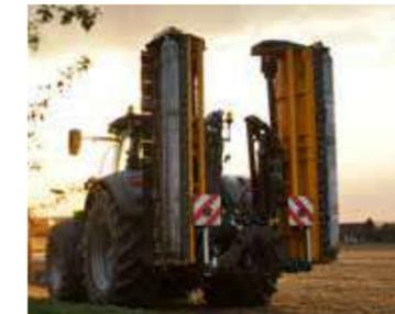
Repliage judicieux : hauteur d'engin minimale grâce à la suspension en parallélogramme des deux carters de broyeur.
