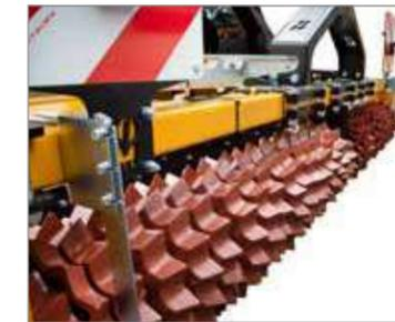
Le rouleau prismatique de 38 cm de diamètre et l'effet de compactage "pas de mouton" éprouvé assurent, en combinaison avec la terre fine, un contact parfait au sol.
