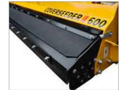
Grand rouleau d'appui avec palier Starinth robuste pour régler la hauteur de travail du broyeur et assurer le contact optimal entre la terre et la graine.
