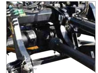
Transmission conçue pour des puissances motrices jusqu'à 400 ch.
