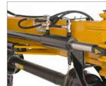
En cas de danger, la sécurité anti-collision hydraulique bascule le broyeur hors de la zone de collision.
