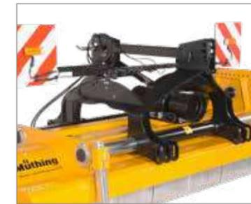
Attelage frontal ou arrière robuste avec déport latéral hydraulique (course de déplacement de 56 cm) et points d'attelage de cat. 2+3.
