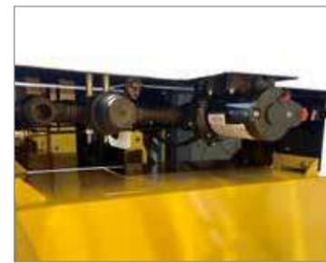
Unité de pompage constituée d'un filtre d'aspiration, d'une électropompe, d'un filtre de refoulement et d'un régulateur de pression.
