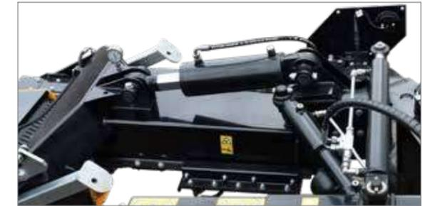
Décharge hydropneumatique de la pression d'appui pour une adaptation optimale au sol.
