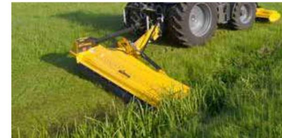
Beaucoup de place pour le montage sur le tracteur et l'arbre de transmission suiveur de mouvement.
