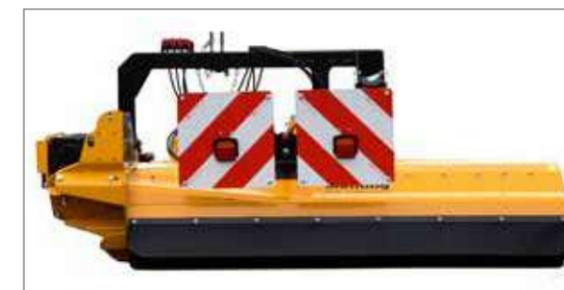
Plaques de signalisation pivotantes avec dispositifs d'éclairage et supports d'éclairage à fixation robuste sans éléments mobiles (en option).
