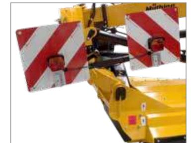
Plaques de signalisation avec dispositifs d'éclairage et supports d'éclairage à fixation robuste sans éléments mobiles
