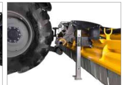
Rapidement opérationnel : dételer la machine, mettre en position de travail le dispositif de transport en long / atteler le MU-Farmer® 670 au tracteur au moyen de la barre à raccord rapide et raccorder l'arbre de transmission.
