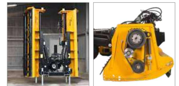
Grâce à sa conception étudiée, le broyeur MU-M/F Vario peut être replié pour un faible encombrement d'entreposage.
