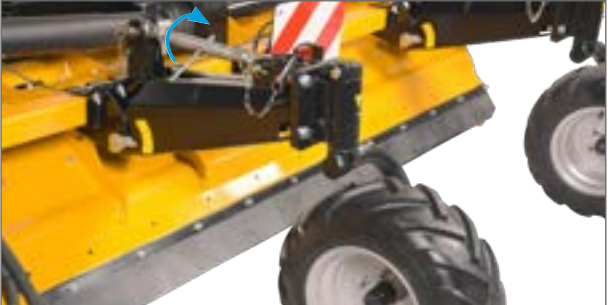
La barre de poussée permet de régler rapidement la hauteur de coupe qui convient.
