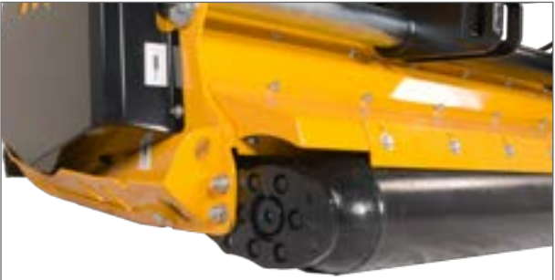
Grands rouleaux d'appui orientables permettant au choix la dépose des résidus devant ou derrière le rouleau et le réglage de la hauteur de coupe (en option).
