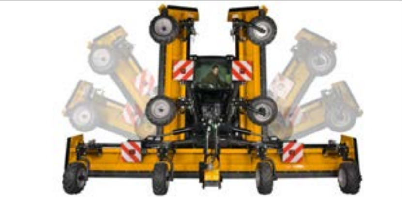
Passage rapide de la position transport à la position de travail. Position de transport dégagée avec une hauteur totale de 2,85 m et une largeur de transport de 3,60 m.
