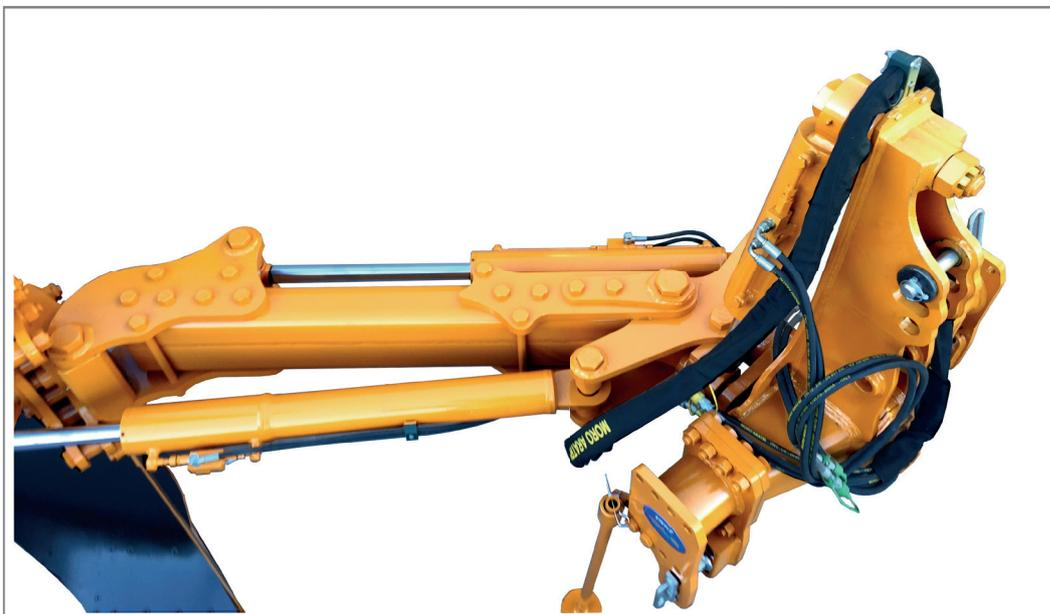
À l'aide du même vérin hydraulique qui permet de régler la largeur de travail, la charrue peut être positionnée pour labourer dans la raie ou hors-raie. De plus, un second vérin hydraulique permet de régler la ligne de traction.
