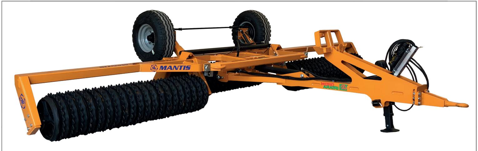
Conçus et fabriqués par MORO Aratri, les rouleaux tractés MANTIS assurent un excellent compactage et nivellement du sol. Ils sont idéaux aussi bien en pré-semis, pour la préparation du lit de semence, qu'en postsemis, pour favoriser le compactage, l'aération et donc une bonne germination des cultures.
