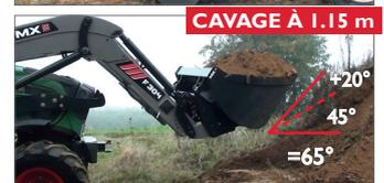
Réserve de cavage : +20° de réserve de cavage à 1.15m de hauteur grâce à la cinématique du chargeur et le dimensionnement des vérins de bennage.
