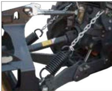
Le dispositif de délestage à ressort avant assure un suivi du sol optimisé ainsi que de meilleures traction et manœuvrabilité du tracteur (en option) du fait de la charge de l'essieu avant.
