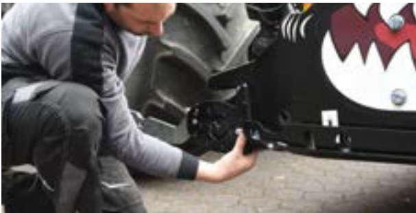
Réglage facile du rouleau d'appui rabattable même sans aide supplémentaire.
