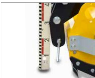
Meilleur suivi en profondeur du broyeur pour les tracteurs à la hauteur d'attelage abaissée Cat. 1+2 (en option).
