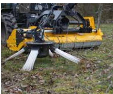
Accessoires hydrauliques supplémentaires tels que : andaineur pour résidus de bois coupé, disque de broyage ou tête faucheuse permettant un usage polyvalent (en option).
