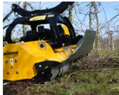
Des patins d'usure spécialement formés et la tôle de guidage résistante assurent un flux optimal (en option).
