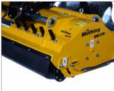
Des râteliers collectent avec fiabilité le bois de taille même dans l'ornière du tracteur grâce à un réglage rapide en profondeur (en option).
