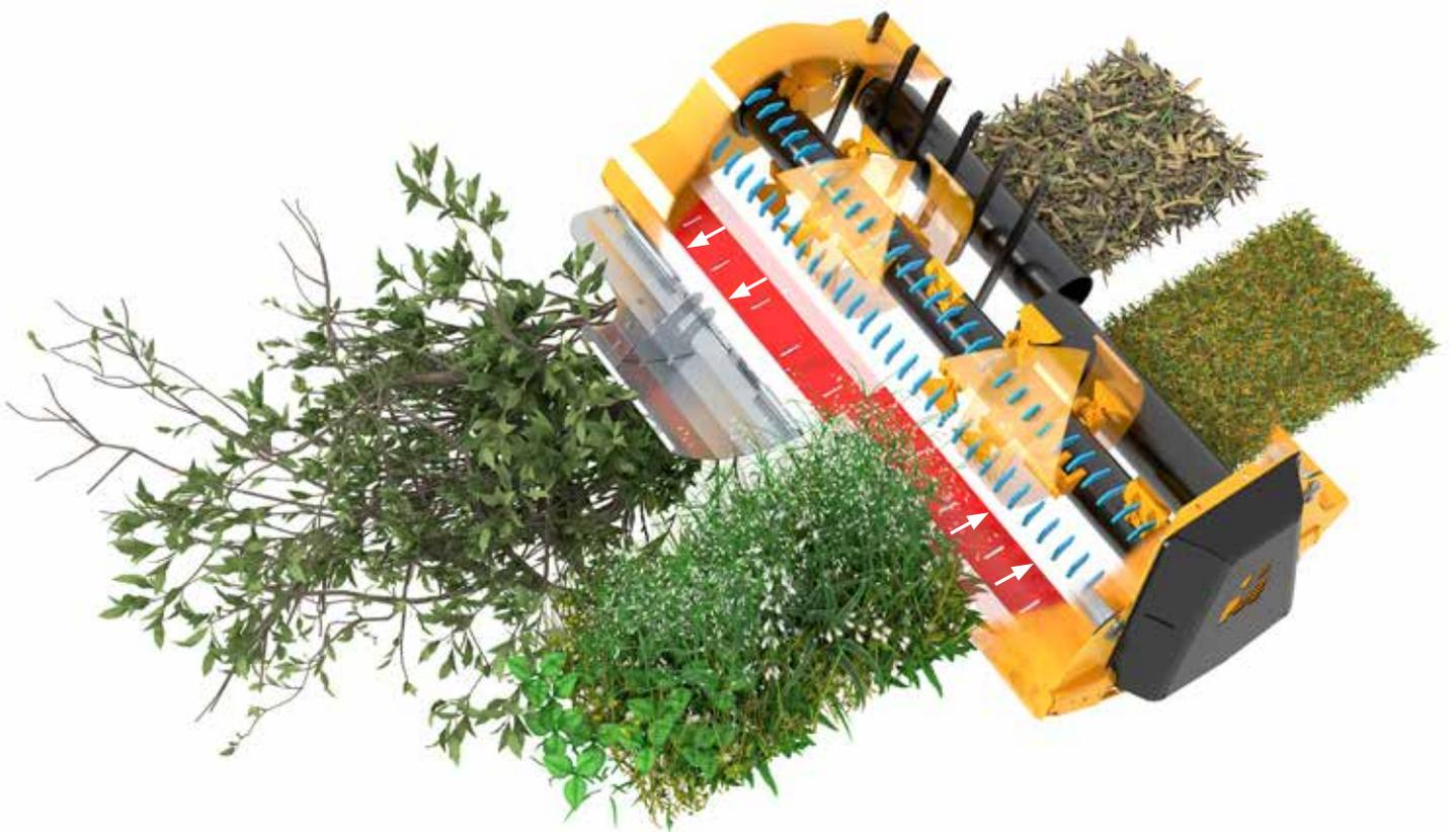
Le système s'adapte de manière adéquate à toutes les conditions grâce à une lame Vario à réglage progressif.
