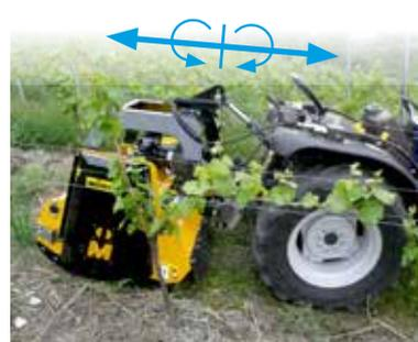
Boîtier avec double roue libre pour les tracteurs ayant différents sens de rotation de prise de force (en option).
