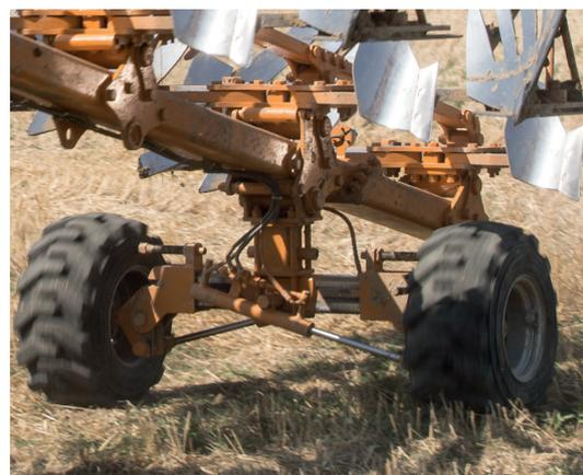
Le passage de la position de travail au système de transport, et vice-versa, est effectué par un entraînement hydraulique. Grâce à la tête d'attelage articulée particulière, la charrue se comporte comme une remorque pendant la phase de transport.
