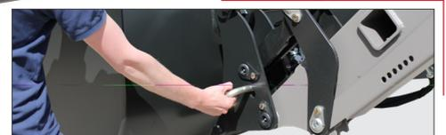
Cadre porte-outil à verrouillage automatique. Poignées de dttverrouillage accessibles de chaque côté du cadre.
