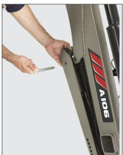
Béquilles intégrées au bras du chargeur. Repliées, elles forment un carter qui protège les flexibles hydrauliques.
