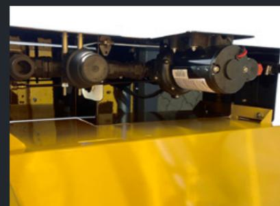
Unité de pompage constituée d'un filtre d'aspiration, d'une électropompe, d'un filtre de refoulement et d'un régulateur de pression.
