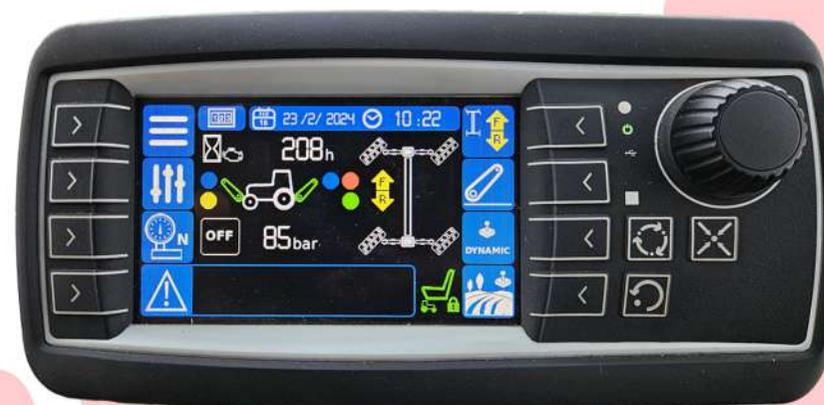
La cabine est équipée d'un écran multifonction qui simplifie le travail de l'opérateur en regroupant diverses commandes et informations. Son interface intuitive offre un accès rapide aux diagnostics en temps réel, aux données opérationnelles et aux paramètres du système, améliorant ainsi l'efficacité et la sécurité en rendant les commandes et les informations essentielles facilement accessibles.
