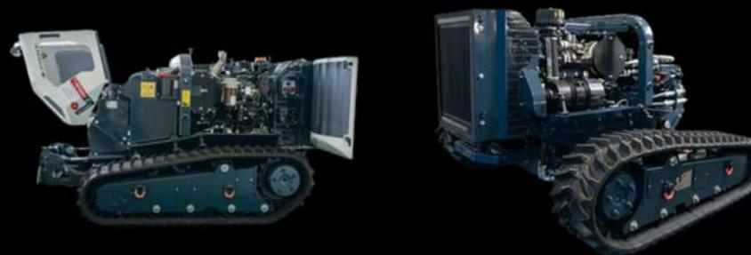
Les ROBOSLOPE sont équipés de moteurs industriels diesel Perkins à faibles émissions, permettant ainsi de réduire leur empreinte carbone.
