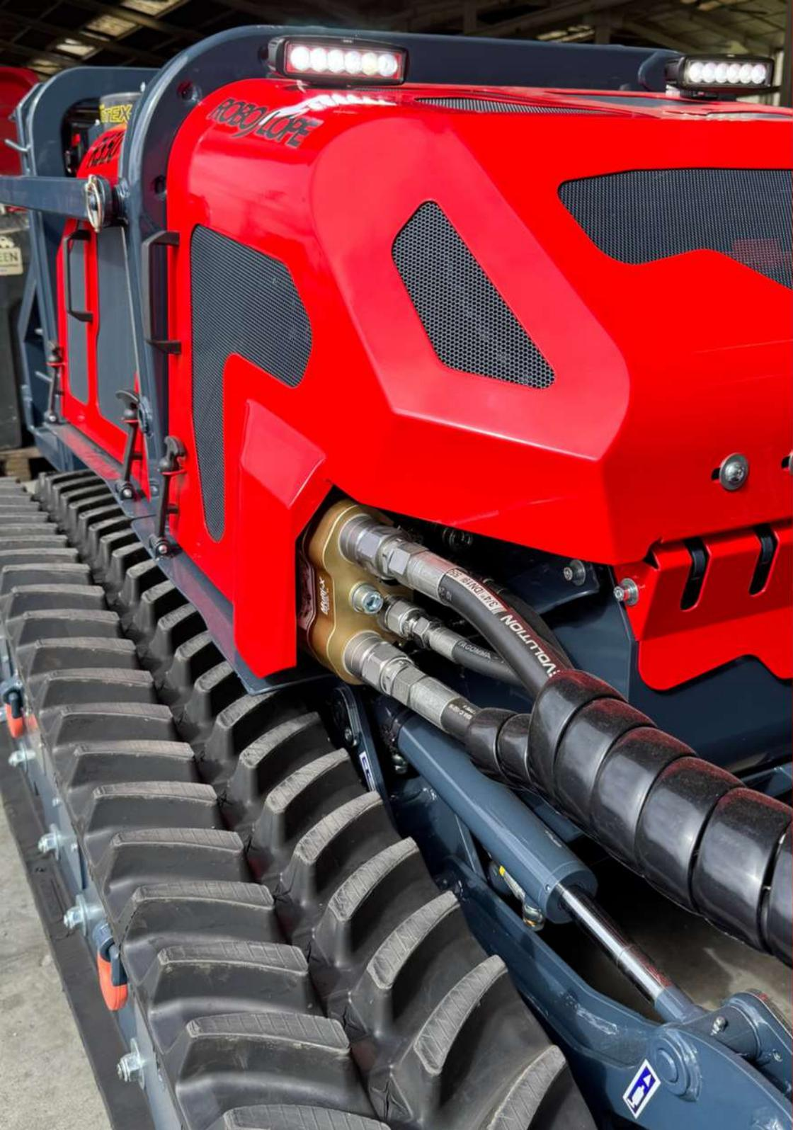
Le **ROBOSLOPE** est équipé de trois pompes hydrauliques montées en série, dont une pour chaque train de chenille et une pour l'entraînement de l'outil.
