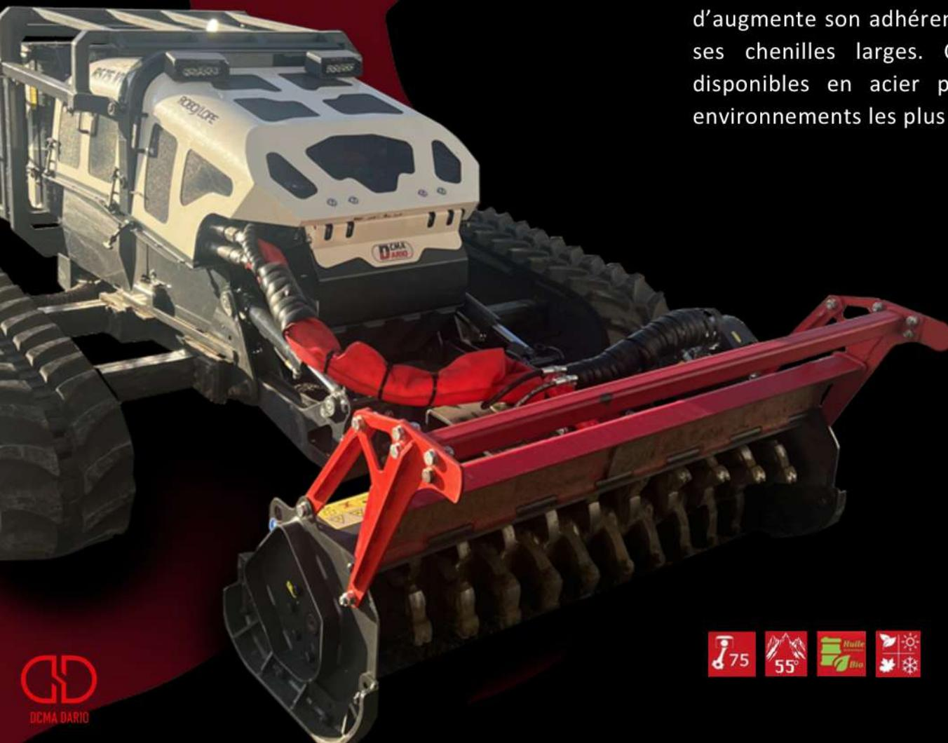
Le RS75VV est le plus gros modèle de la gamme Roboslope. Tout comme les autres, il est aussi muni d'une voie variable qui lui permet d'élargir son empatement de 800 mm grâce à ses trains de chenilles à écartement hydraulique indépendant.
