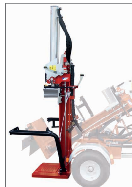
Mise en position de travail hydraulique
