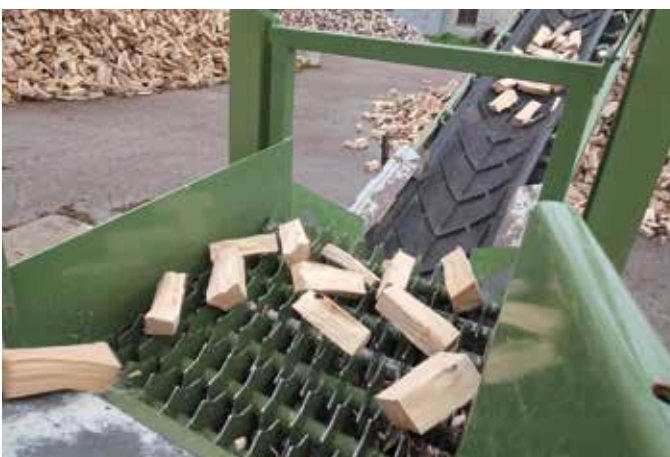
Rouleaux de nettoyage pour morceaux d'écorce et sciure de bois
