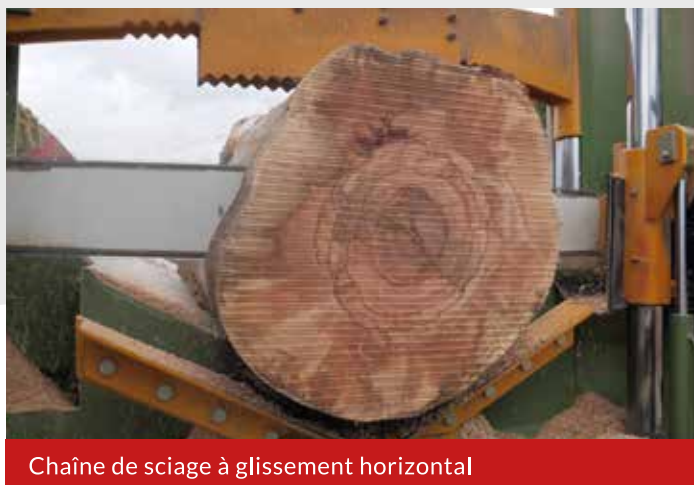
Blocage à guillotine hydraulique du bois
