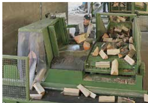
Station de fendage 11 Tonnes, grille 2+4 voies
