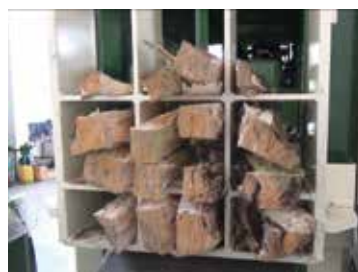
Grille de fendage GENIUS WEDGE conçue pour obtenir du bois de chauffage calibré en un seul passage en optimisant les diamètres et en minimisant les déchets.
