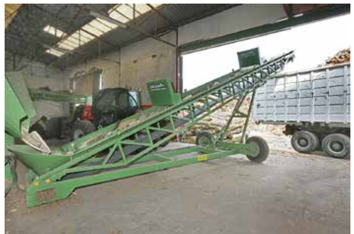
Orientation hydraulique sur roues avec convoyeur
