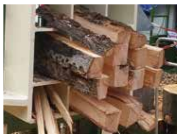
Grille de fendage GENIUS WEDGE conçue pour obtenir du bois de chauffage calibré en un seul passage en optimisant les diamètres et en minimisant les déchets.
