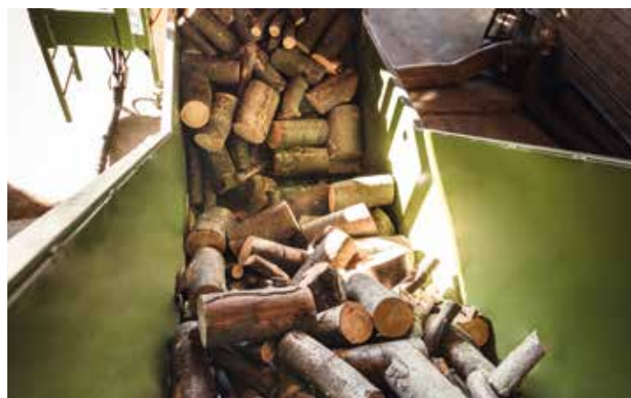
Convoyeur d'accumulation de matériau coupé
