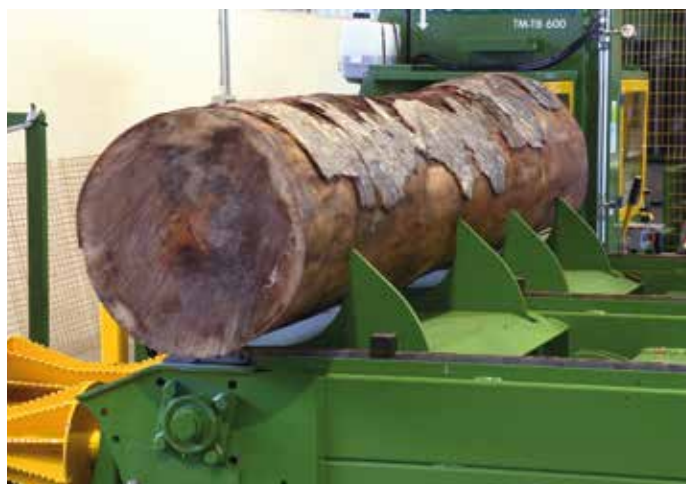
Chargeur de grumes à 3 chaînes, longueur 4 mètres
