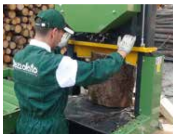
VS 60 – Coin courbé avec 4 couteaux orbitaux VS 60 – Double commande hydraulique manuelle
