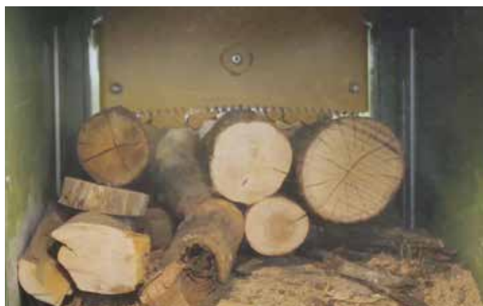
Blocage à chaîne hydraulique du bois
