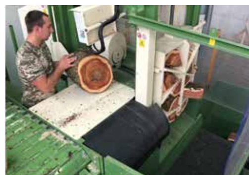
Station de fendage 20 Tonnes, grille 2+4 voies
