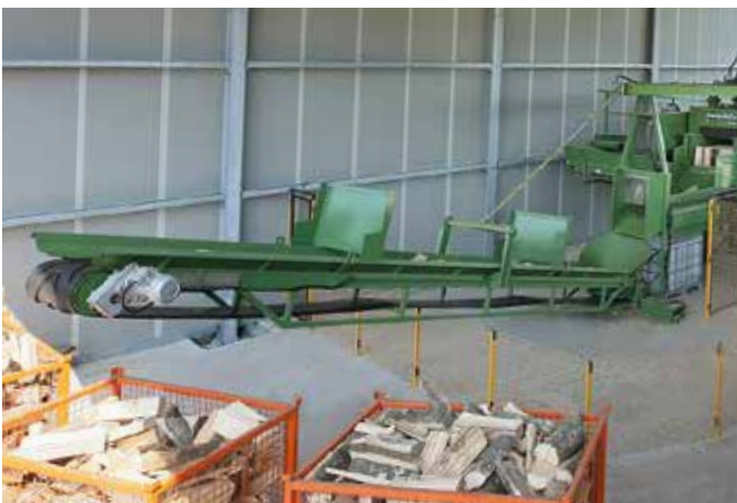
Orientation hydraulique fixe avec convoyeur
