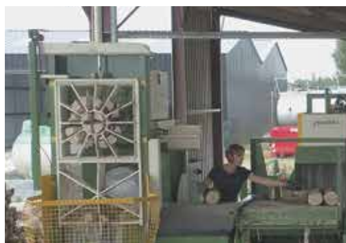
Station de fendage 32 Tonnes, grille 2+4+6+16 voies
