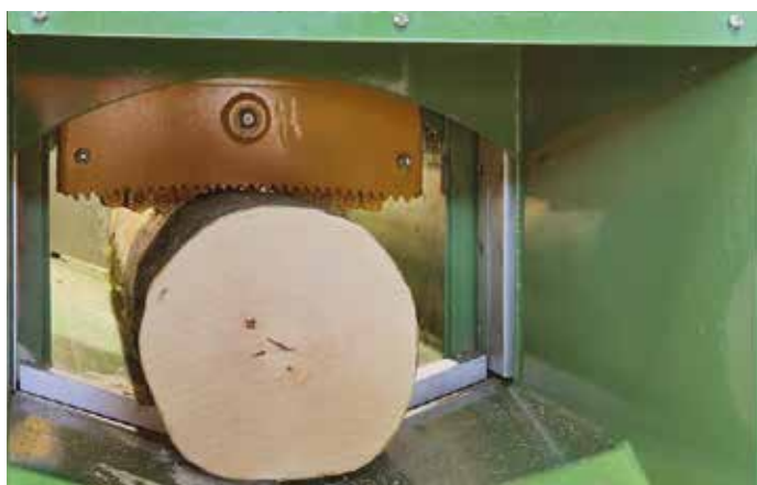
Alimentation avec des troncs
