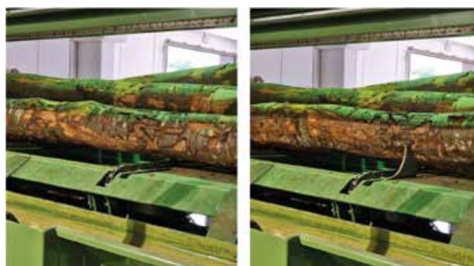
Système de chargement en demi-lune dissimulé
