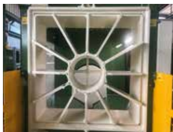
Secteur de fendage démontable pour entretien avec 10 ou 12 ou 16 ou 18 ou 24 voies
