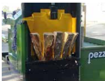
VS 60 – Coin courbé avec 4 couteaux orbitaux VS 60 – Double commande hydraulique manuelle
