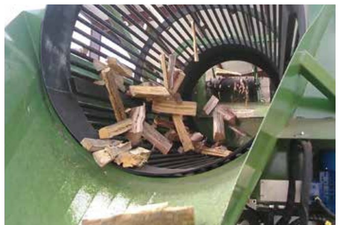
Crible à tambour pour morceaux d'écorce et sciure de bois
