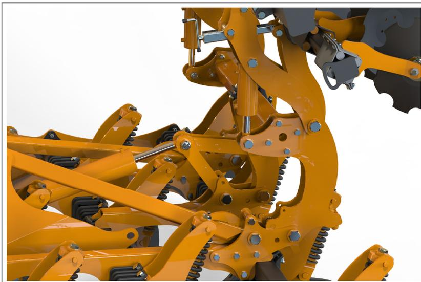
Le système particulier de tiges permet aux disques ou au rouleau du groupe de pivoter à plus de 90 degrés. Ainsi, le centre de gravité du cultivateur se trouve dans une position très avantageuse, réduisant la charge sur le système de levage du tracteur et facilitant le transport routier.
