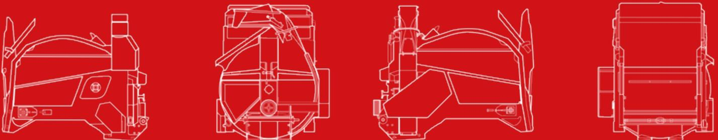
Le **POWERDRIVE**, permet un fonctionnement indépendant de la turbine, du démêleur et du fond mouvant. Le système d'entraînement du démêleur par courroie débrayable hydrauliquement diminue fortement la puissance requise au démarrage et limite considérablement les risques de bourrages.
