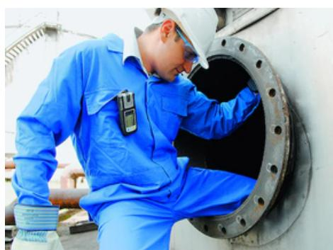
La pompe externe en option munie d'un tuyau allant jusqu'à 45 m constitue la solution idéale pour les mesures d'autorisation d'accès dans les réservoirs ou les puits et pour les recherches de fuite. La pompe démarre automatiquement dès que le détecteur de gaz est mis en place. Le passage du mode diffusion au mode pompe se fait rapidement, facilement et sans outil.
