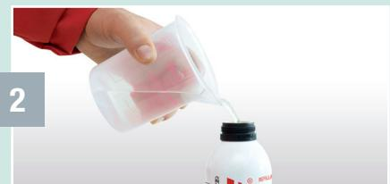
Dévisser la partie supérieure de l'aérosol et remplir avec le nettoyant Loctite® 7063 jusqu'à 300 ml, maximum.
