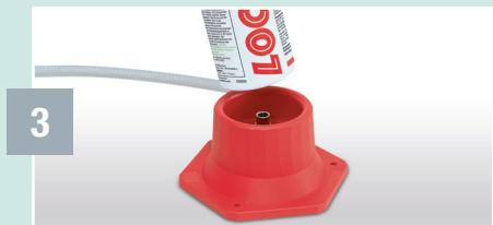
Revisser fermement la partie supérieure et placer l'aérosol sur la station de recharge. Mettre sous pression avec de l'air sec comprimé (0,8 MPa / 8 bar / 116 PSI).
