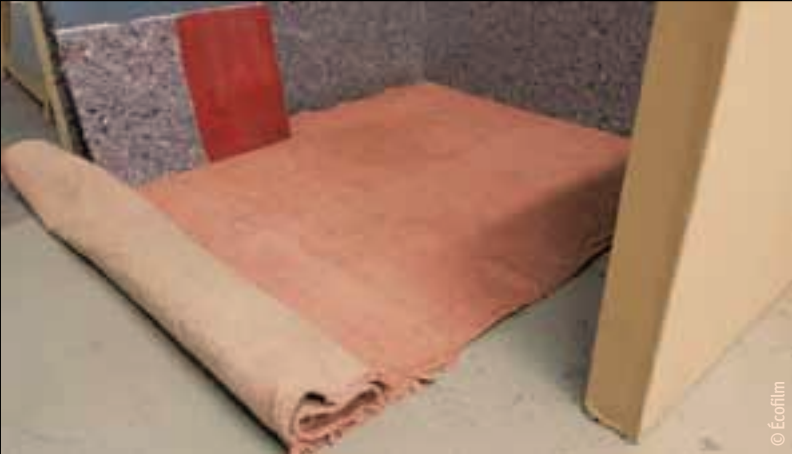
Écofilm met au point et teste des matières écologiques pour la réalisation des décors, comme ici cette texture à base de chanvre et de lin.
