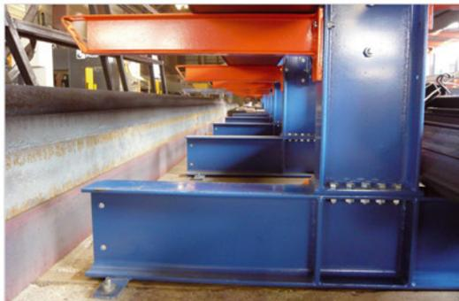
L'assemblage boulonné (colonne et embase) assure une excellente rigidité verticale et permet de transformer un cantilever simple face en double face et inversement.
