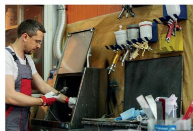
Nettoyage et entretien de matériels d'application de peintures : pistolets, crochets, caches, etc.
