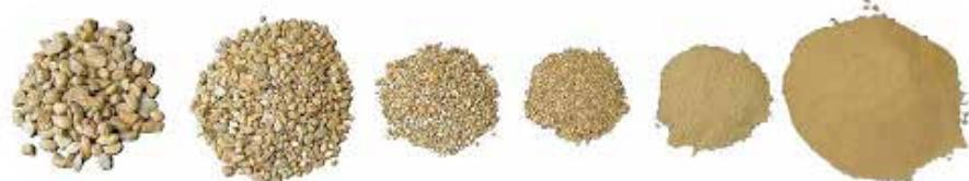
**Ce traitement des minéraux permet la production de sable à béton et gravier propre et de qualité constante.**
