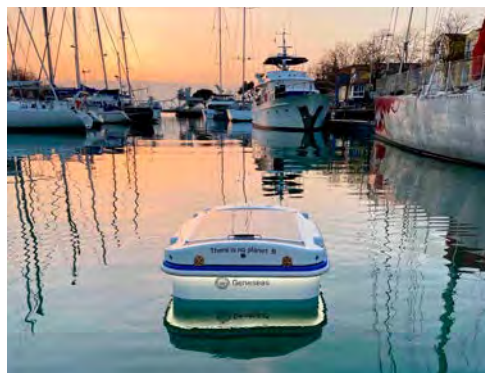
Geneseas collecte les déchets en surface et revient à sa base en autonomie ou en pilotage manuel.
