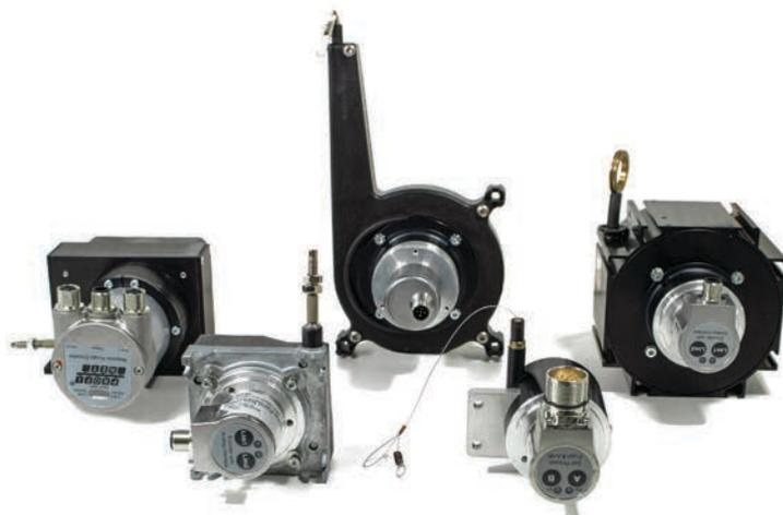
Les capteurs à câbles, également appelés capteurs à fil, sont conçus pour réaliser des mesures de positions linéaires grâce à un encodeur, ce qui leur donne un surcroît de sensibilité. Connecté à un câble de traction, l'encodeur livre un signal proportionnel à l'étirement du câble. Alors qu'un pignon ou des racks requièrent une soudure et un alignement parfaits, un capteur de câble de traction permet l'installation facile d'un système avec une large gamme d'interfaces.
