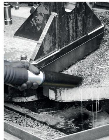
*Le Tecnoil 200 a été créé pour répondre aux besoins des industries mécaniques et d'ingénieries nécessitant un aspirateur puissant et compact, capable de fonctionner en continu sur les chaînes de production dans un souci d'ergonomie et de sécurité pour les opérateurs.*
