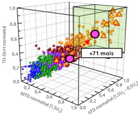
Représentation en 3D de la corrélation entre les paramètres d'évaluation normalisés de mesures de TD MTD,  $\Delta$ TD et TD-Skirt : la zone encadrée en haut à droite de l'image indique une forte probabilité de défaut.
