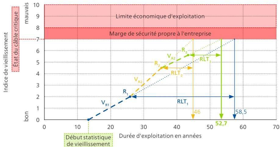
Une première mesure de TD, après une durée d'exploitation DP (duty period) de 26 ans donne, pour l'indice de vieillissement  $R_1$  du câble, une valeur de 2,0. On peut ainsi calculer, après la première mesure, la vitesse de vieillissement  $V_{R1}$ . Grâce à la vitesse de vieillissement, il est possible de calculer, après la première mesure, la durée de vie résiduelle statistique RLT (remaining life time) du câble.
