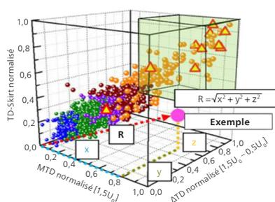
Lorsqu'une deuxième mesure est effectuée et que l'indice de vieillissement R est à nouveau déterminé, il est possible de calculer, sur la base des indices R des deux mesures, la vitesse de vieillissement et la durée de vie résiduelle à attendre de la liaison câblée. Ainsi, en faisant la différence entre la limite économique d'exploitation et la marge de sécurité propre au fournisseur d'énergie, on peut déduire le moment où des travaux deviendront nécessaires sur la liaison câblée.
