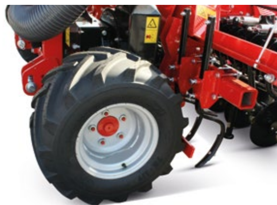
Ruote 26.00-12 26.00-12 wheels Räder 26.00-12 Roues 26.00-12 Ruedas 26.00-12
