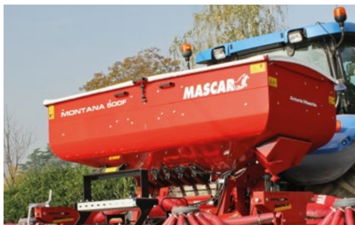
Rialzo tramoggia (500 L) Hopper extension (500 Lt.) Erhebungssatz der Saatbehälter (500 Lt.) Hausse tremie (500 L) Altura tolva (500 L)
