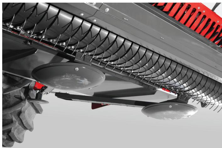
La grande réactivité aux changements de terrain garantit une usure moindre de l'unité de pick-up. Comme l'andain est propre et exempt de cailloux et de sable, un travail en toute sécurité avec une moissonneuse, une presse à balles ou une autochargeuse est également garanti.
