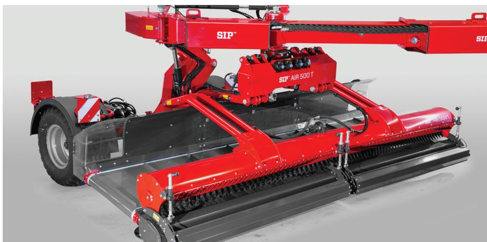
Le pick-up flexible de 5 m s'adapte parfaitement à tous les types de terrain sur toute la largeur de travail. Le système assure un andainage de qualité et il peut également être utilisé pour retourner ou fusionner les andains.
