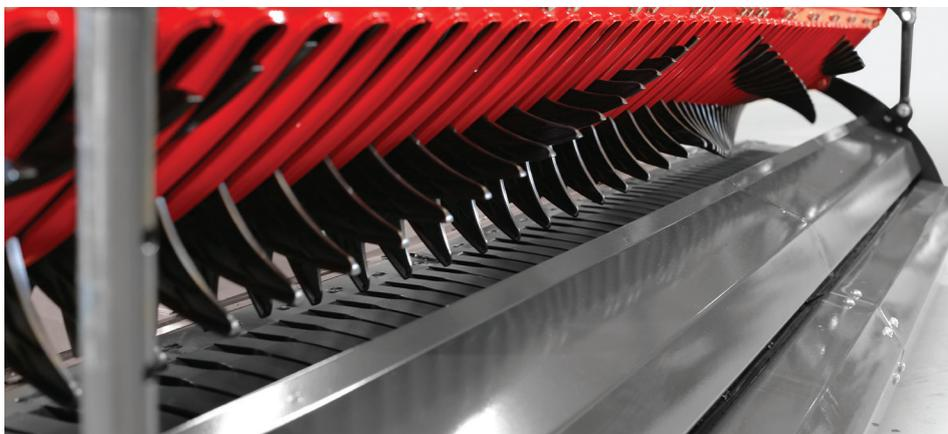
Le rotor à doigts et l'unité de pick-up assurent un flux de fourrage parfait.
