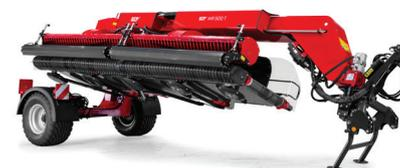
Le châssis télescopique flexible place la machine dans une position de transport compacte.
