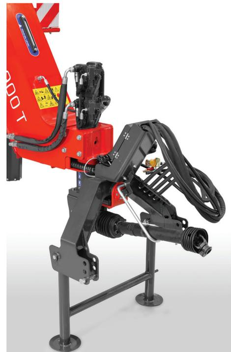
Un attelage 2 points avec une pompe hydraulique double variable par le biais de l'arbre à cadran.
