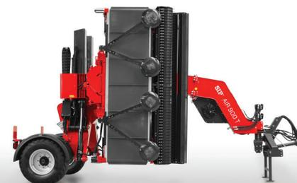
La position de transport compacte avec un train de roulement court permet une manipulation confortable de la machine et une stabilité pendant le transport.
