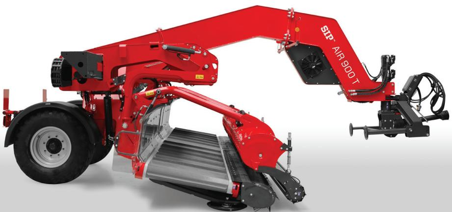
La conception bien pensée dotée de deux unités de pick-up montées sur traîneau garantit l'efficacité et la fiabilité sur différents terrains. La combinaison d'un dispositif de pick-up flexible de petit diamètre et de bras traînés à ressort réduit les risques de présence de pierres et d'impuretés dans les fourrages.
