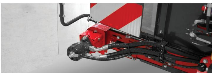
La direction et la vitesse du tapis transporteur sont réglées par un moteur hydraulique.
