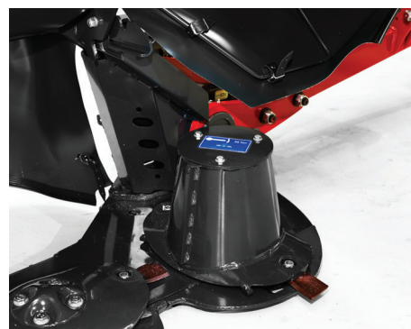
La transmission via la boîte de vitesses placée derrière le premier disque empêche l'accumulation de fourrage à l'intérieur de la barre de coupe.
