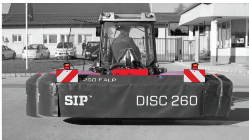
Le déport latéral hydraulique (en option) permet de déplacer la faucheuse de 200 mm vers la gauche ou vers la droite et assure un flux constant de fourrage entre les roues du tracteur même en cas de travail sur terrains pentus. L'adaptation latérale au sol est de \pm 10^\circ .
