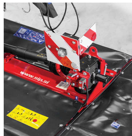
Équipement de sécurité routière et d'éclairage
