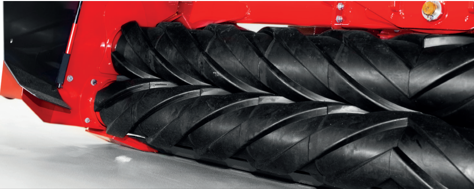
Les rouleaux en caoutchouc profilés en forme d'hélice tournent les uns contre les autres et compriment les tiges dans le sens de la longueur, permettant une perte d'humidité rapide.
