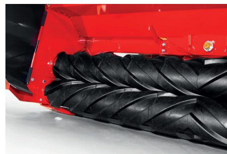
Le conditionneur de caoutchouc à rouleaux (RRC) permet de conditionner uniformément le fourrage de luzerne et de trèfle. L'intensité du conditionnement est réglable en continu.
