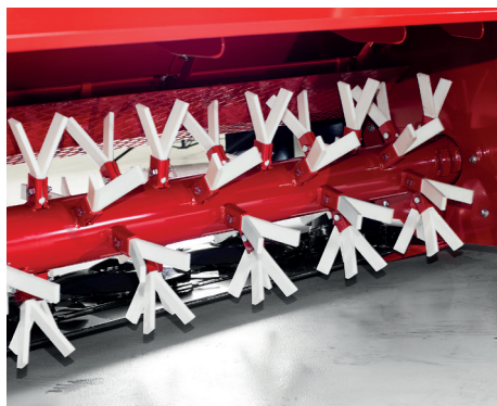
Les doigts en plastique rigide grattent et cassent la cuticule cireuse des feuilles et des tiges, et brisent les tiges.
