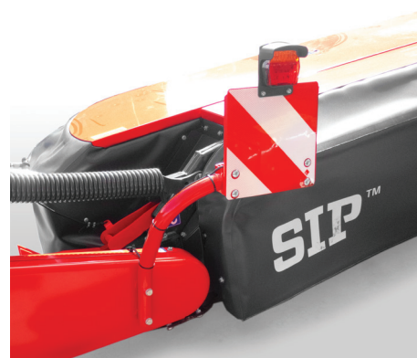
Équipement de sécurité routière et d'éclairage
