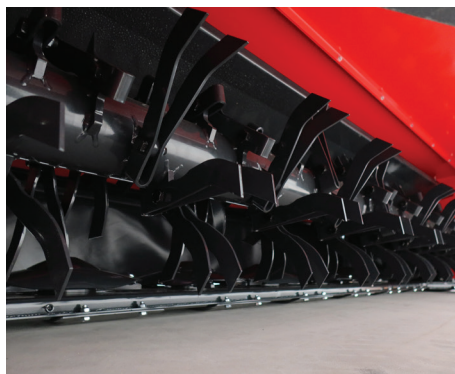
Les doigts d'acier flexibles endommagent, cassent et brisent les tiges, permettant ainsi une perte rapide d'humidité.
