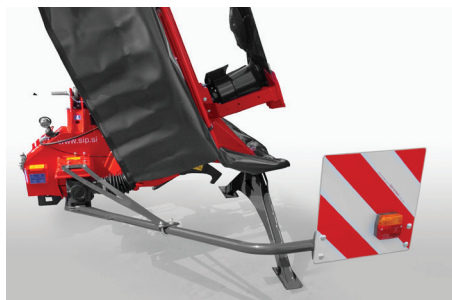
Équipement de sécurité routière et d'éclairage
