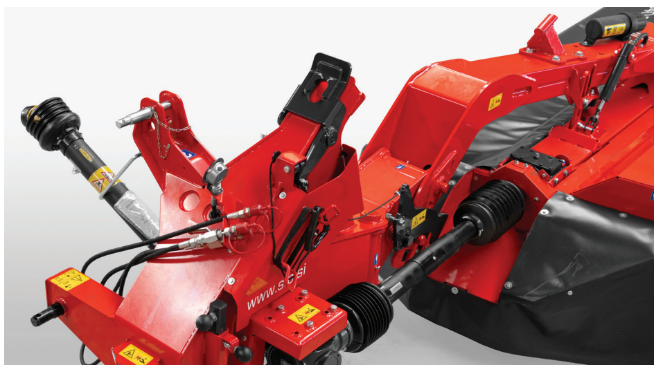
L'attelage avec un système de transport sécurisé séparé du bloc de levage partiel de la barre de coupe permet une bonne maniabilité lors des virages en bout de champ.
