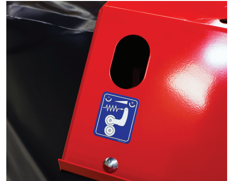
Avec le réglage de l'intensité de conditionnement, la pression des rouleaux peut être réglée en fonction de la quantité et du type de fourrage.
