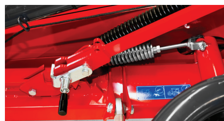
Le blocage de la faucheuse en position de stationnement évite le risque de relevage due à la pression dans le vérin et permet une fixation facile au tracteur.
